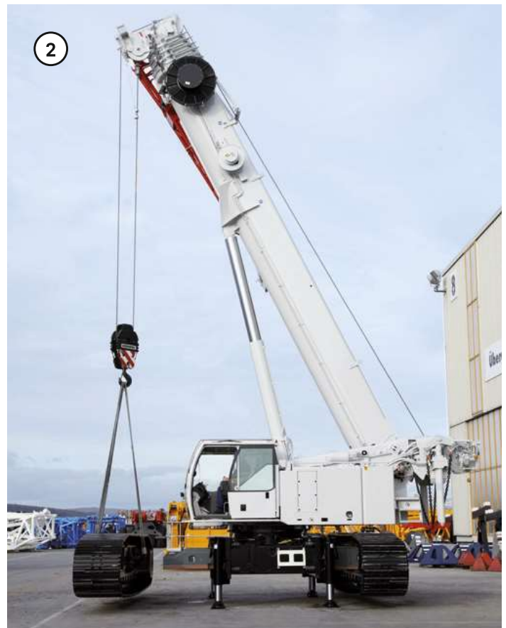
3 Jack-up cylinders with retracted crawlers Vérin jack-up avec longerons rentrés
